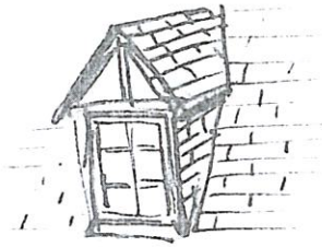
Lucarne à bâtière
