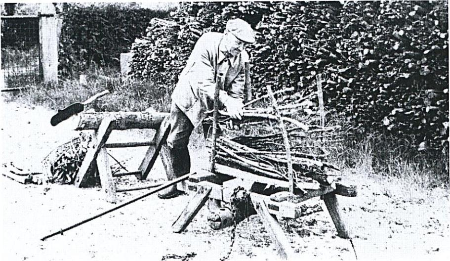
soin de poser d'abord les plus grosses branches qui formaient le *parement*. Le serrage était obtenu par un moulinet à crémaillère mû par une *tavelle* (barre de fer arrondie) et qui entraînait une chaîne. Lorsque le fagot était suffisamment serré, on bloquait la crémaillère au moyen d'un cliquet métallique appelé *renard* et on liait les branches avec un fil de fer.
