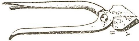
Chien: le chien se compose de deux mâchoires en fer mobiles autour d'une goupille. Les mâchoires sont percées de deux trous filetés dans lesquels pénètre une vis. Le chien sert à monter les chaussures, en particulier la cambrure.
